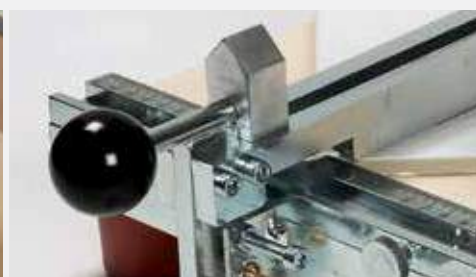
Brechvorrichtung Top Dahm Art. 11 360 zum Schlagen der Fliese.
